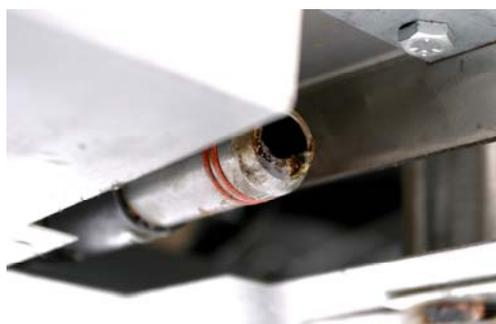
5. Assurez-vous que les joints toriques sur le tube de prélèvement sont intacts.
