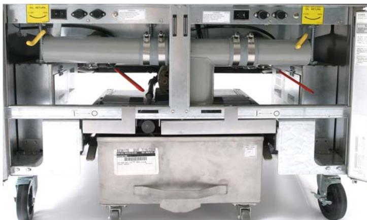
Retirez le bac du filtre de l'armoire de la friteuse.
