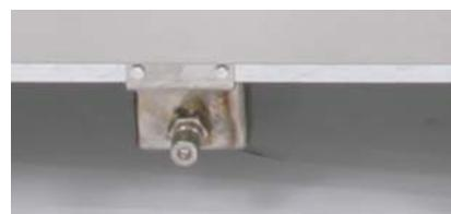
Connectez le bras flexible de mise au rebut par le biais de la déconnexion rapide à l'avant de la friteuse.
