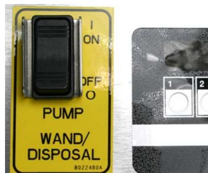
Avec le bras flexible dirigé dans la cuve, mettez la pompe en marche à l'aide de l'interrupteur situé à l'avant.
